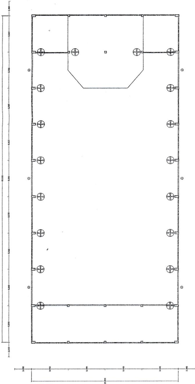
แปลนพื้นที่อาคารแบบประหลาด 1 ติดตั้งท่อลมขนาด 24 นิ้ว จำนวน 18 ชุดสำหรับติดตั้งที่ด้านนอกผนังงาน
